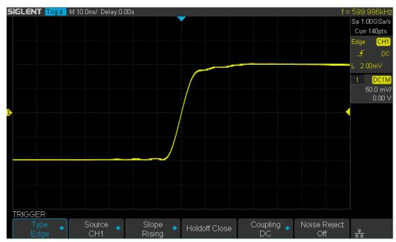
Figure 28 Edge Trigger
