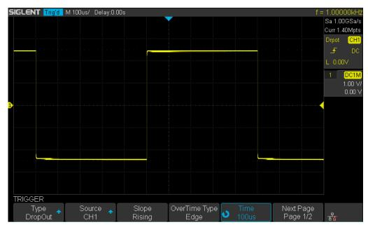
Figure 35 Edge DropOut Trigger
