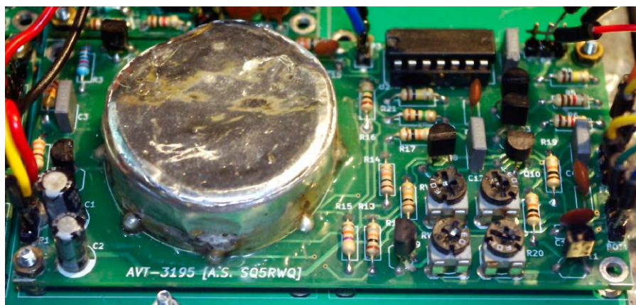
Fotografia 5. Moduł VFO z zaekranowanym właściwym generatorem
