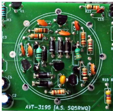
Fotografia 4. Główna część generatora VFO przed zaekranowaniem
