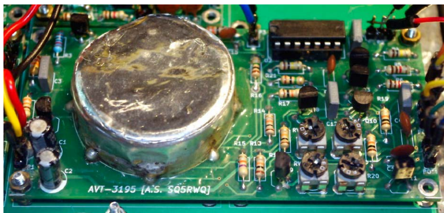
Fotografia 5. Moduł VFO z zaekranowanym właściwym generatorem
