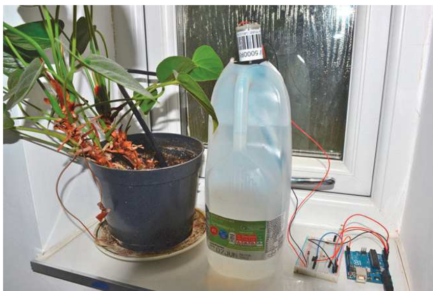
Rysunek 7.16. Urządzenie podlewające domowe kwiaty
