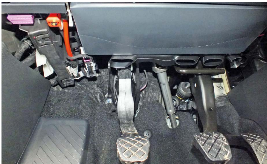
Fotografia 4. Umiejscowienie gniazda OBD II w nowych samochodach
