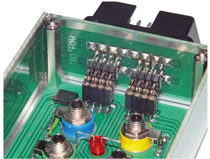
Fotografia 16. Sposób połączenia wyprowadzeń złączy z płytką z gniazdami
