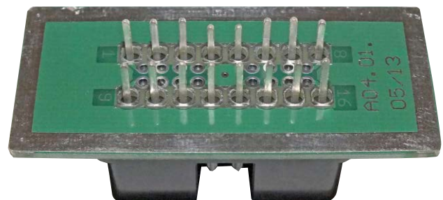
Fotografia 14. Sposób montażu wtyku OBDII
