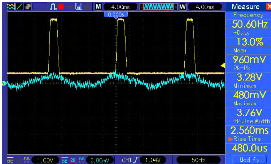
Rysunek 2. Oscylogramy napięć na wejściu (niebieski) i wyjściu (żółty) wzmacniacza
