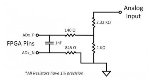
Figure 7.2.1. Analog input circuit.
