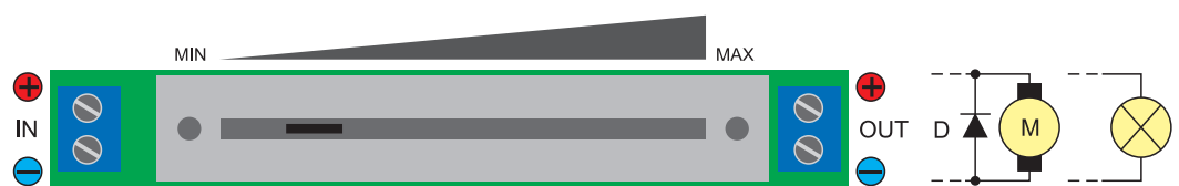
Rysunek 3. Sposób dołączenia obciążenia do ściemniacza LED
