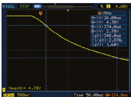
Rysunek 2. Wykres zależności napięcia podtrzymania w funkcji czasu w momencie wyłączenia zapłonu
