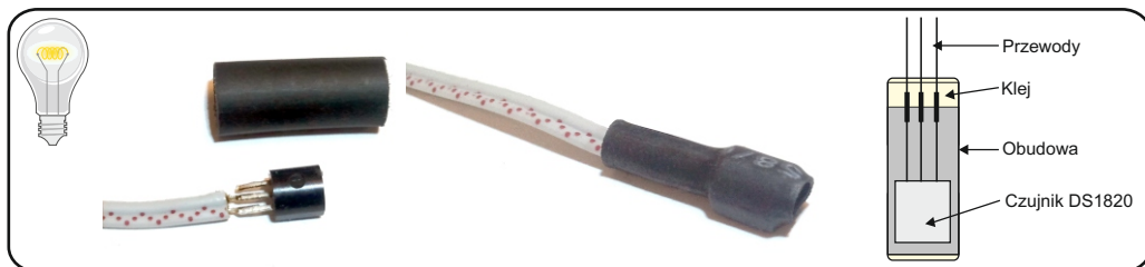
Przykład zabezpieczenia czujnika
