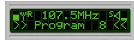
Rysunek 7. Zapamiętanie ustawionej częstotliwości
