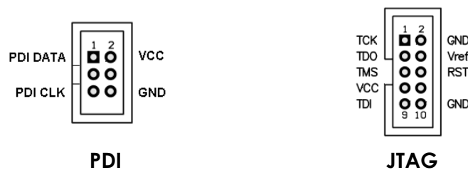
Rys. 2. Pinout złącz programujących
