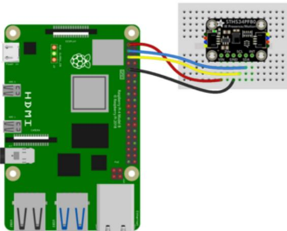
Pi 3V to breakout VIN (red wire)
