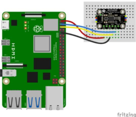
Pi 3V to breakout VIN (red wire)
