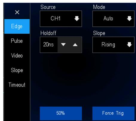
Figure 9.2 Edge trigger menu
