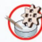
ENG Wax the part with a regular candle (rub with a candle). UKR Змастіть деталь звичайною свічкою (потріть об свічку). FRA Lubrifiez la pièce avec une bougie ordinaire (frottez contre la bougie). DEU Reiben Sie das Teil mit einer einfachen Kerze etwas ein. ITA Incerare il componente (Sfregare con la cera). JAP 表示された部分に潤滑剤としてロウソクを塗ってください。 CHI 用普通蜡烛涂抹润滑部件。SPA Engrase la pieza con una vela común (frote con una vela). RUS Смажьте деталь обычной свечкой (потрите о свечку).
