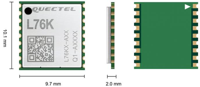
L76K 是一款支持多卫星系统（GPS、BeiDou、GLONASS、QZSS）、可多系统联合定位和单系统独立定位、支持 AGNSS 功能、内置低噪声放大器和声表面滤波器、可向用户提供快速、精准、高性能定位体验的 GNSS 模块。
