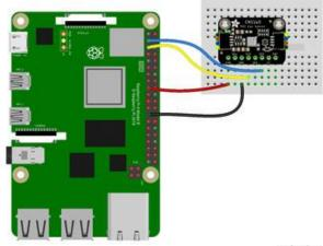
Pi 3V to sensor VIN (red wire)
