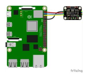
Pi 3V to sensor VIN (red wire)
