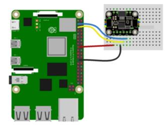
Pi 3V to sensor VIN (red wire)
