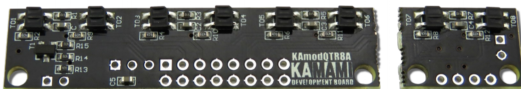
Rys. 1. Widok modułu KAmoDQTR8A z odłamanymi czujnikami
